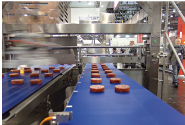
Быстрее, точнее, гигиеничнее: WEBER Pack Robot распознает вид и размеры любой мясной продукции на линии фасовки
