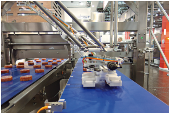
Быстрее, точнее, гигиеничнее: WEBER Pack Robot распознает вид и размеры любой мясной продукции на линии фасовки
